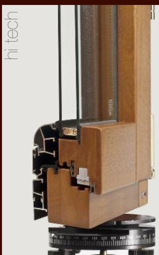
Le finestre e le portefinestre denominate EURO MIX sono composte da telai di sezione 56x70 e da ante sezione 58x81 in legno e da rivestimento in alluminio lega 6060 verniciato, la giunzione dei montanti e dei traversi delle ante è realizzata a mezzo di tenoni ricavati nei profili stessi, incollati con colla di classe D4; la verniciatura viene effettuata con una mano di impregnante e di intermedio protettivo a flow-coating ed una mano di finitura trasparente.
